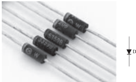
图 1-11 二极管的外形及电路符号
