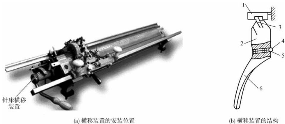
图1-13 横机后针床横移装置
