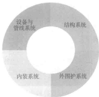
图 1-1 装配式建筑在国家标准定义里的4个系统示意图
