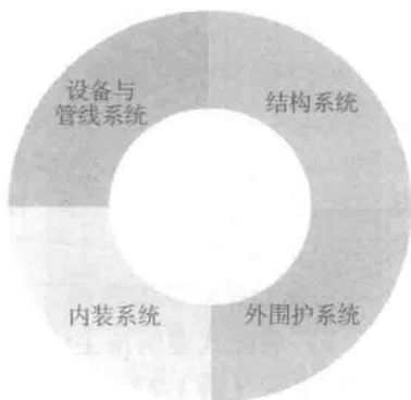
图 1-1 装配式建筑在国家标准定义中的 4 个系统
