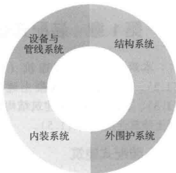
图 1-1 装配式建筑在国家标准定义里的 4 个系统示意图
