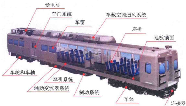
图 1-2 城市轨道交通车辆构成的主要子系统(组件)
