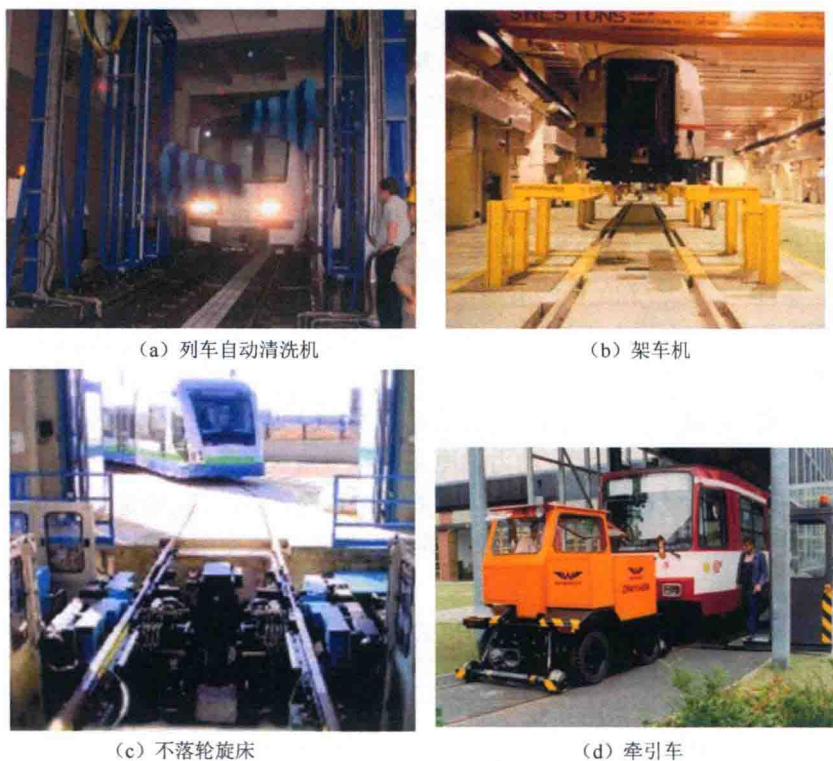
图 1-4 车辆段所配置常用车辆检修设备
