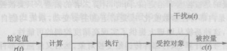
图 1-8 按给定值操纵的系统原理方框图
