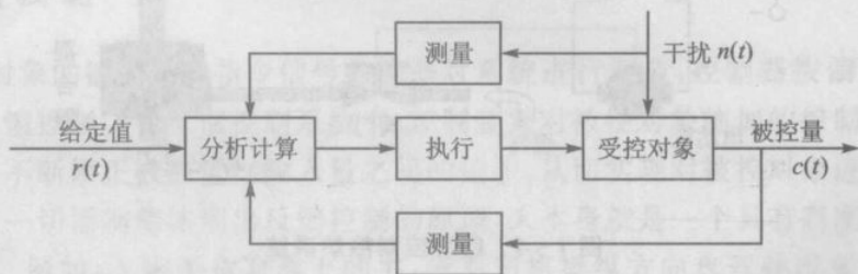
图 1-7 自动控制原理方框图
