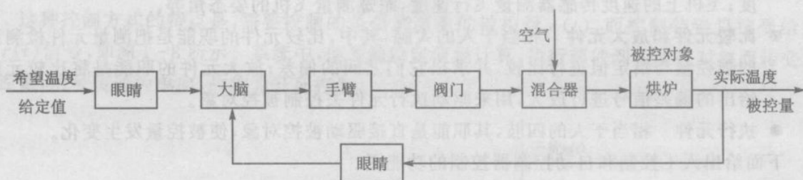
图 1-3 人工控制热炉系统原理图
