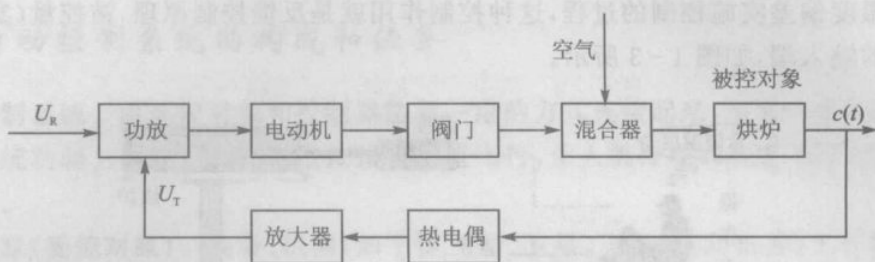
图 1-5 自动控制热炉系统原理图
