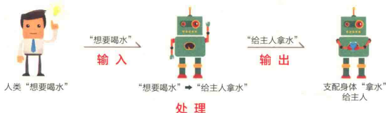
图 1.16 机器人“拿水”动作的产生
