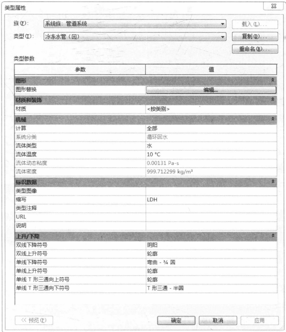
图 2-3 设置管道系统的类型属性
