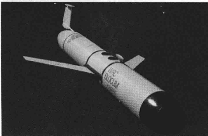
图 1.6 鱼雷体加水平翼设计的 Glider
