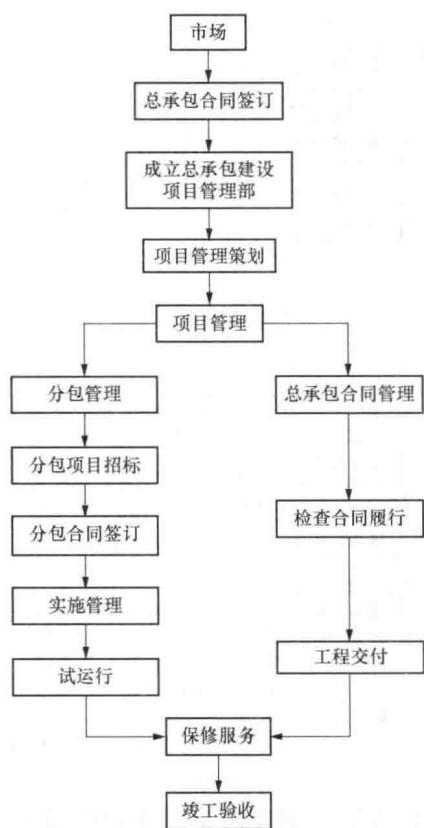
图 1-3 工程竣工验收流程
