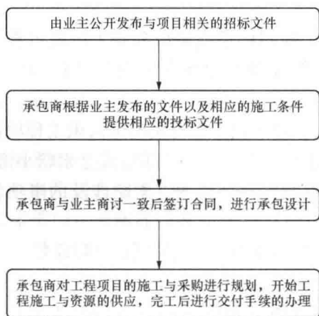
图 1-2 EPC 工程总承包项目的运作程序
