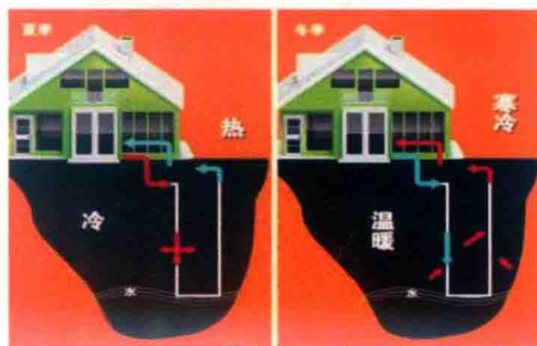
(b) 地源热泵加热示意图
