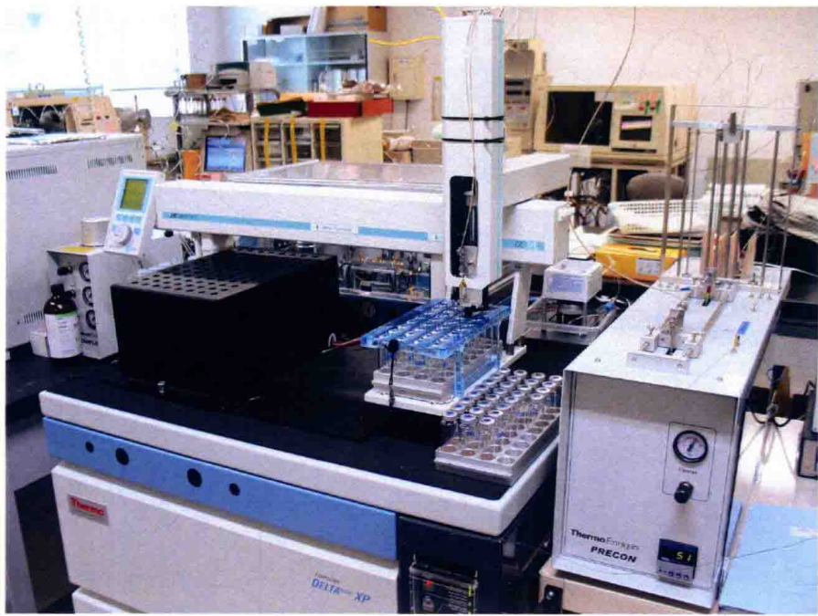
封面图片 16: 测定硝酸根离子内氮、氧稳定性同位素比值时使用的气体稳定性同位素质谱系统: Precon/GasBench/IRMS system (Delta plus XP, Thermo Electron Co., Germany)。本系统使用的是脱氮细菌法。
