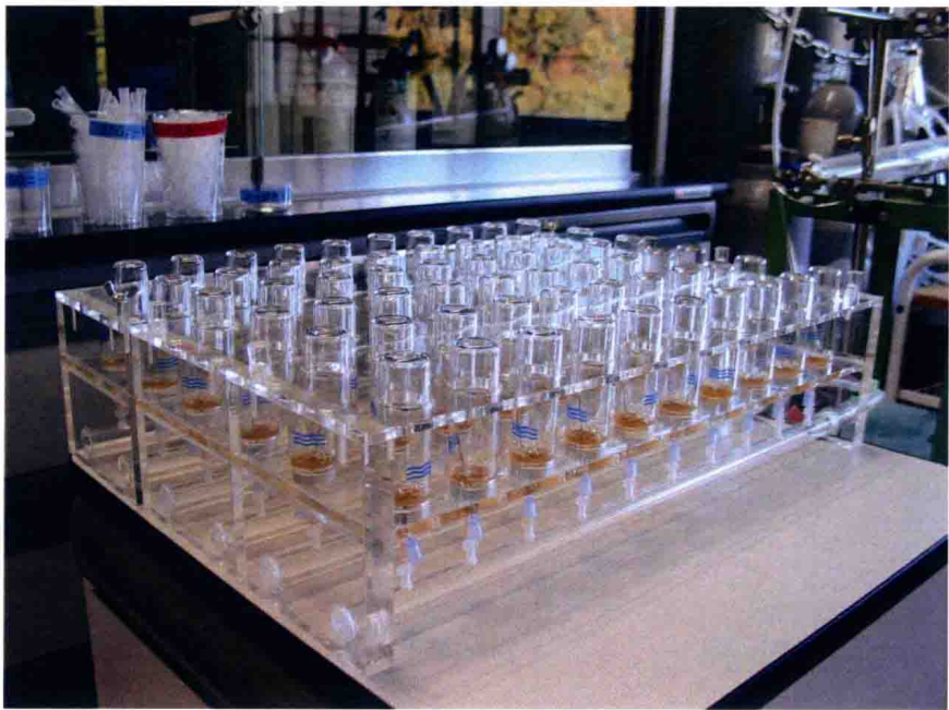
封面图片 17: 在测定硝酸根离子的氮、氧稳定性同位素比值时使用的样品预处理装置。
