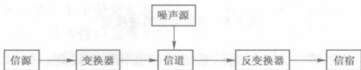
图 1.7 通信系统的基本模型
