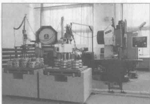
图 1-10 柔性制造系统中的两台加工中心
