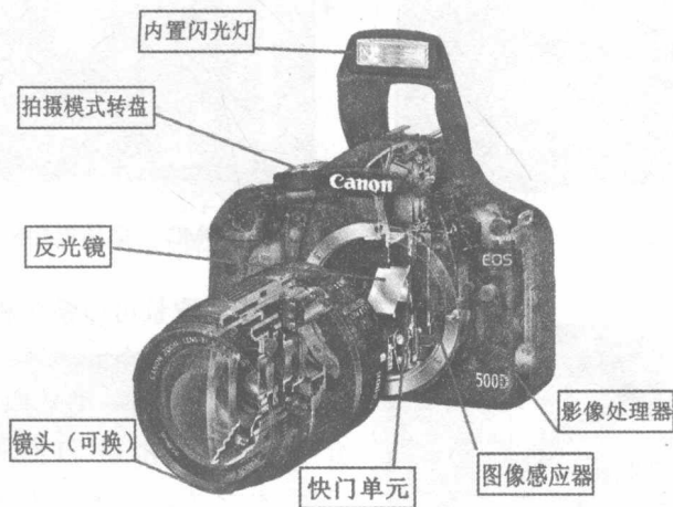
图 1-3 数码单反相机的主要部件
