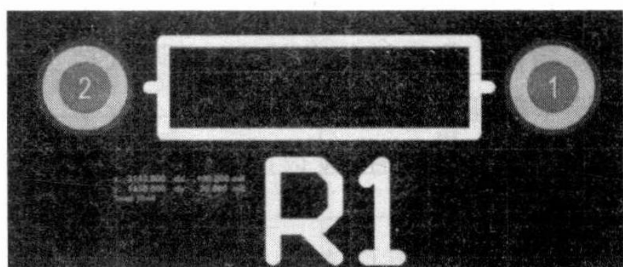
图 1.4 DXP 软件中直插色环电阻的封装
