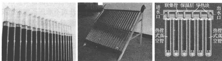
图 1-7 全玻璃热管集热器示意图
