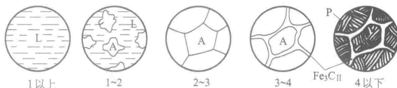
图 1-7 过共析钢结晶过程示意图
