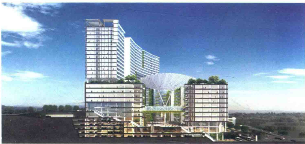
为了在较小的建设用地上容纳大量的床位，深圳市吉华医院采用了高层设计，为了应对庞大的车流，设计了多层地下停车场。
