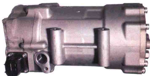
图 1-2-4 北汽 EV160 电动压缩机
