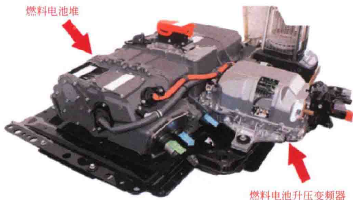
图 1-2-14 燃料电池堆和燃料电池升压变频器
