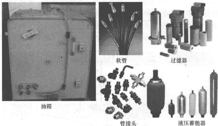
图 1-5 不同类型的液压系统辅助装置
