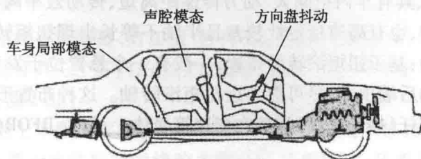
图 1-1 振动传递给车身引起的 NVH 问题
