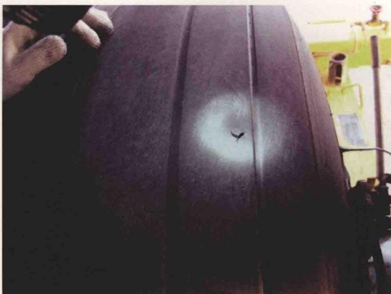
图 1.3 轮胎 FOD 损伤形貌（三角形切口）
