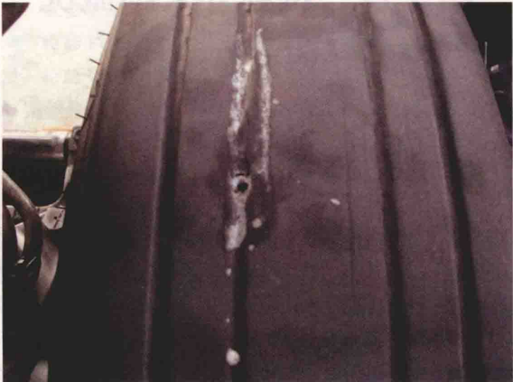
图 1.1 轮胎 FOD 损伤形貌（圆形孔洞）
