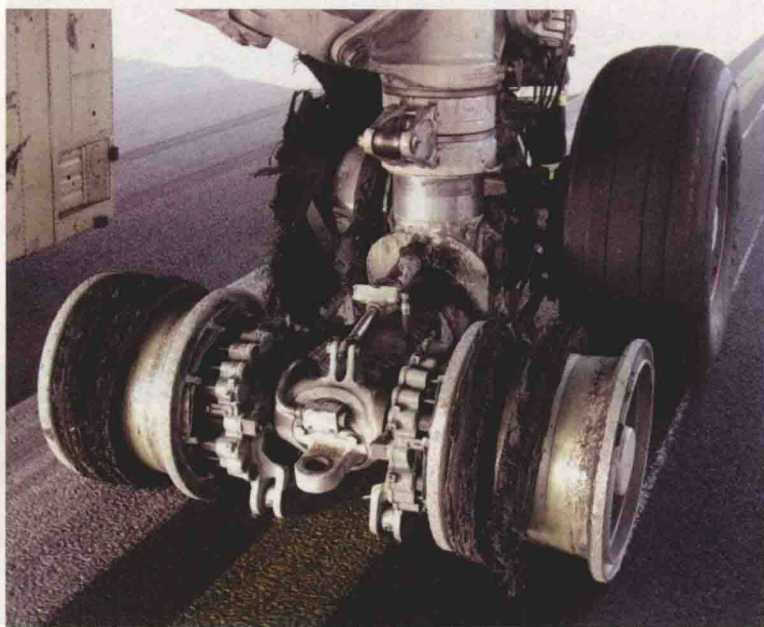
图 1.9 两个爆破的主轮轮毂及轮胎损伤形貌
