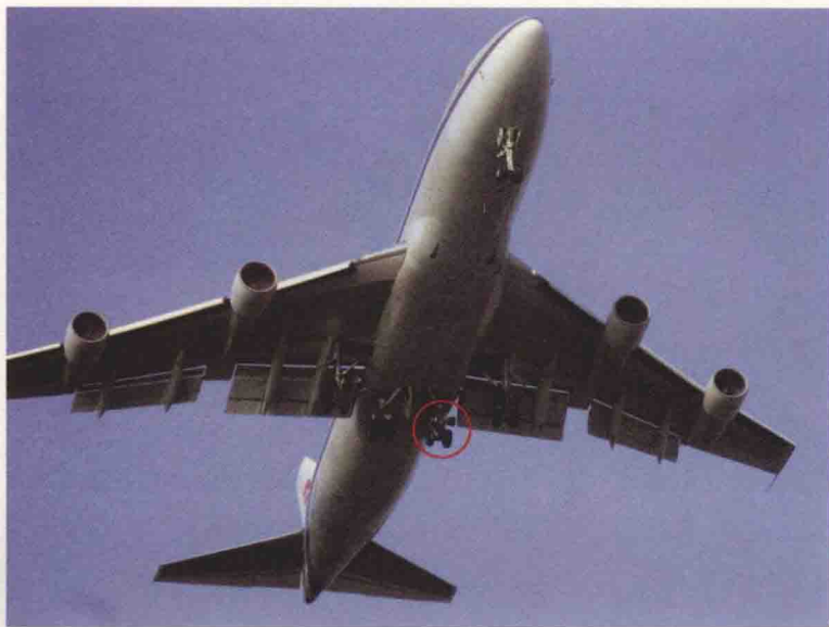
图 1.8 飞机通场飞行检查轮胎受损情况（圆圈内为受损轮胎）
