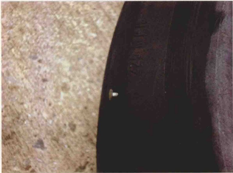
图 1.5 轮胎 FOD 损伤形貌（轮胎上带有 FOD）
