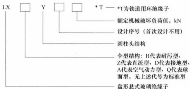
图 1-12 普通玻璃绝缘子的型号表示方法
