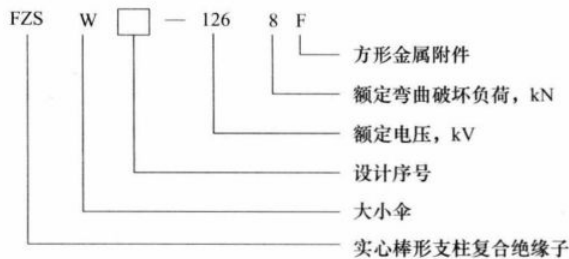
图 1-15 支柱复合绝缘子型号说明
