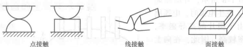
图 1-6 触点的接触形式
