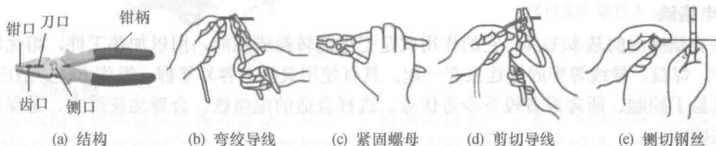
图 2-5 钢丝钳的结构和用途
