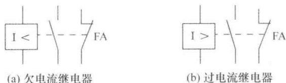
图 1.9 电流继电器的图形符号
