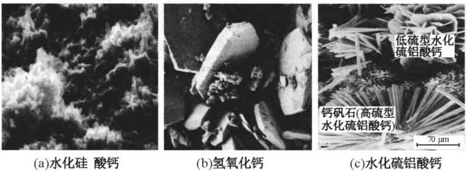
图 1.2 几种水化产物的微观形貌
