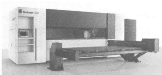
图 1-3 数控激光切割机
