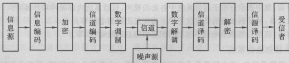
图 1.1.3 数字频带传输通信系统模型
