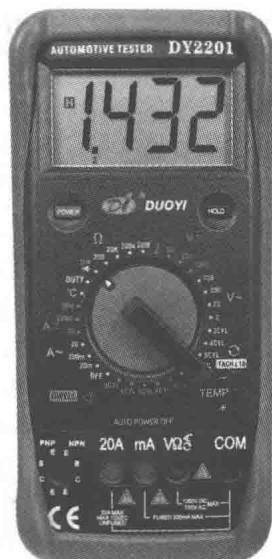
图 1-6 DY2201 数字万用表的外形及面板分布
