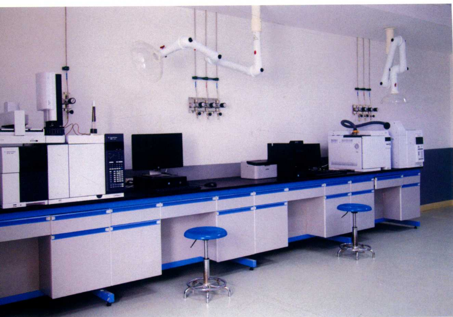
气相色谱-质谱联用检测室（左侧为气相色谱-质谱联用仪，右侧为顶空气相色谱仪）
