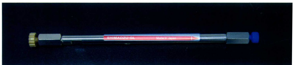
色谱柱（高效液相色谱法用，SHIMADZU-GL，图中红色箭头方向指流动相淋洗方向）
