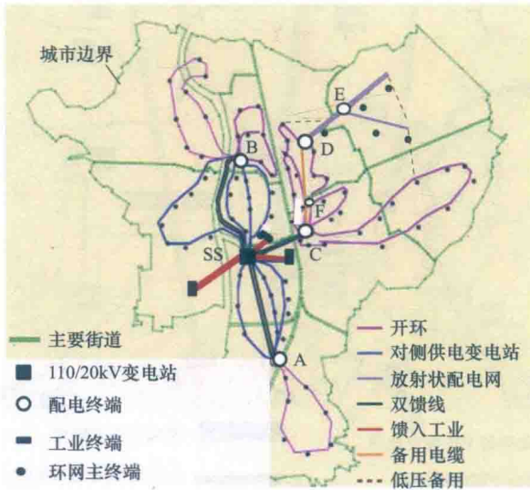
图 4.14 20kV 城市电网接线地图
