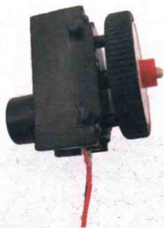
图 12 将轮子安装到电机的输出轴上
