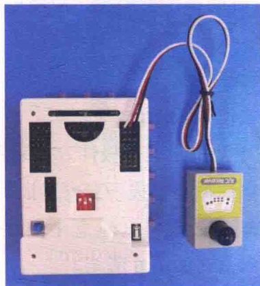
图 4 红外接收器与 QTSTEAM 控制器的连接示意图
