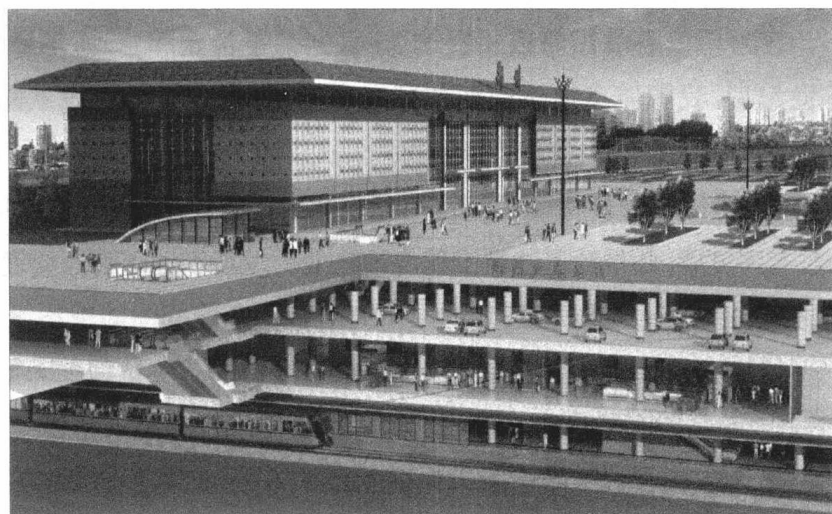
图 1-12 地下停车场 + 轨道交通
