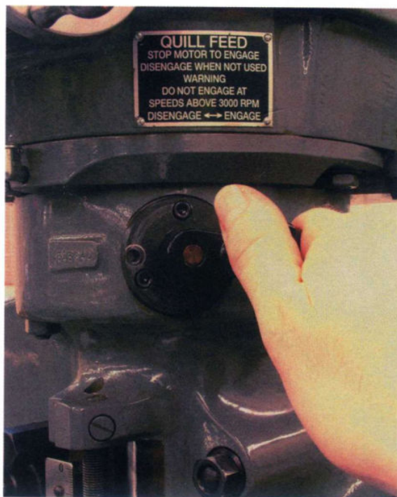
图 1-19 自动进给传动啮合手柄参与到主轴套筒自动进给中
