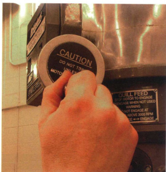
a) 转动变速转盘来调整旋转主轴转速
