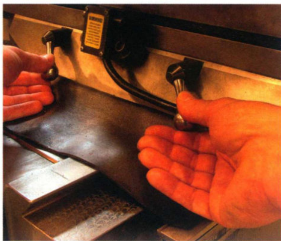
图 1-8 工作台上的锁紧机构可保护工作台，避免不想要的位移
