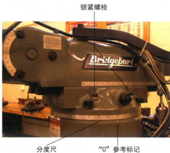
图 1-10 立式铣床的转塔能旋转。注意分度尺和锁紧螺栓
