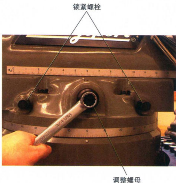
图 1-11 悬臂调整螺母和锁紧螺栓
