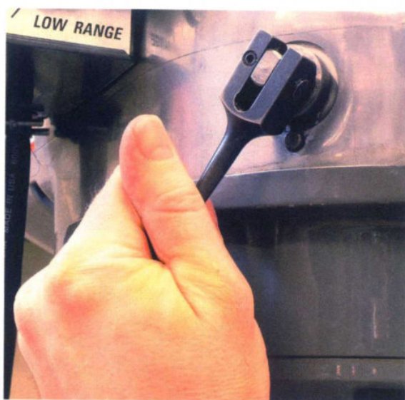
图 1-16 铣床旋转主轴制动杆的作用
