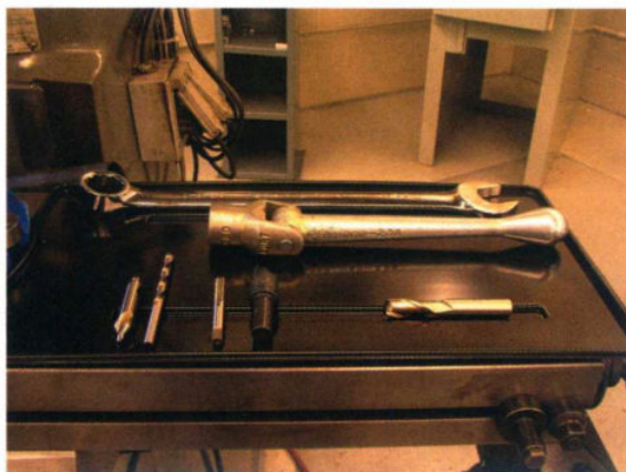
图 1-9 用塑料托盘可以保护铣床工作台表面不被粗糙工具和零件损坏
