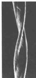
图1-3 棉纤维的纵向形态
