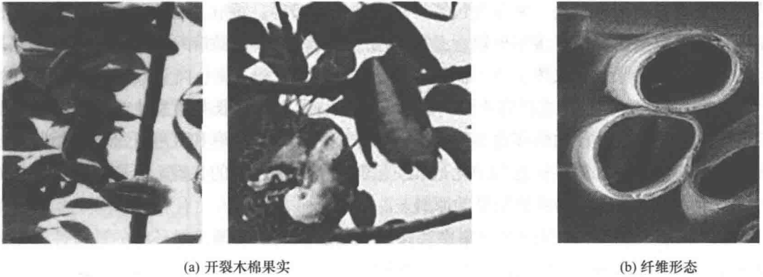
图1-4 木棉纤维果实及纤维形态
