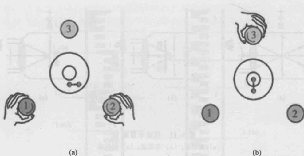
图 1-9 圆水准器气泡居中操作示意图
