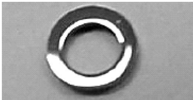
图 1-1 测量磁性矫顽力用的拓扑环形样品
