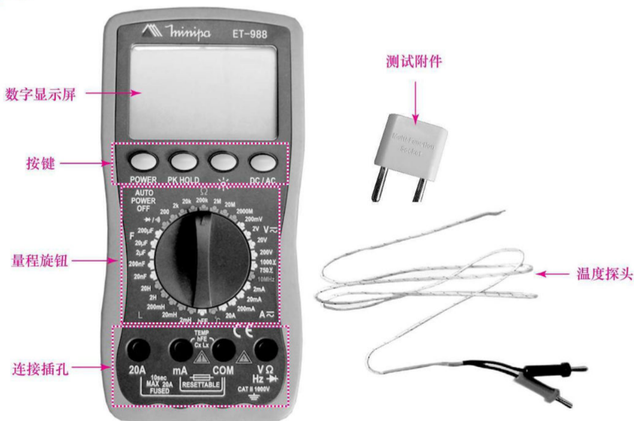
图 1-8 数字式万用表的结构
