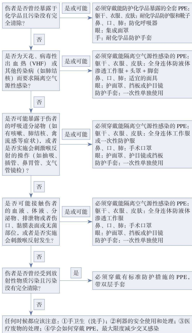
图 2.1 个人防护装备选择流程图
