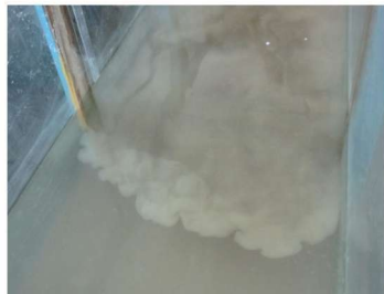
图 1-2 水槽中的浮泥被扰动后以密度流形式运移
