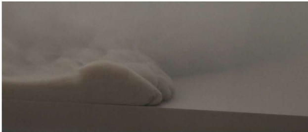
图 1-1 浮泥沿泥质斜坡向下流动
