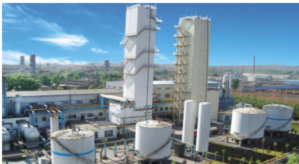
四川空分设备（集团）有限责任公司生产的30000Nm 3 O 2 /h空分装置
