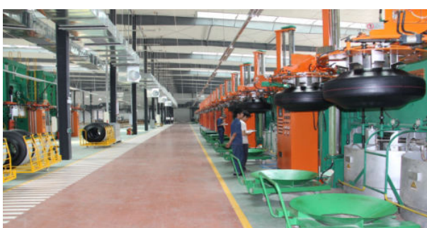
四川凯力威科技股份有限公司成品硫化工序生产车间
