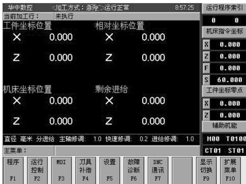
图 1-6 开机后“急停”状态
