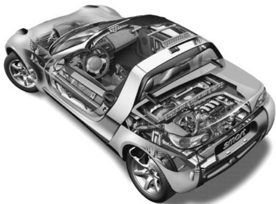
图 1-9 发动机后置后轮驱动 (RR)
