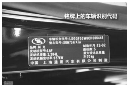
图 1-4 发动机前横梁铭牌上的 VIN
