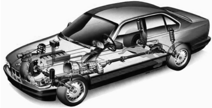
图 1-10 发动机前置全轮驱动 ( nWD )
