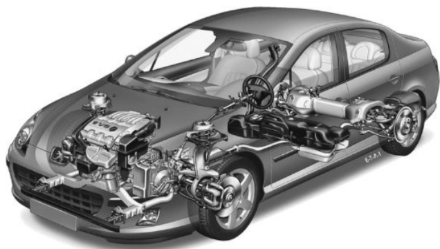
图 1-8 发动机前置前轮驱动 (FF)
