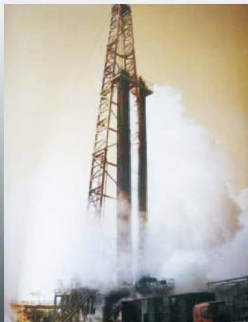
MR7000型钻机已服役32年，累计施工地热井100余眼，总进尺30余万米
