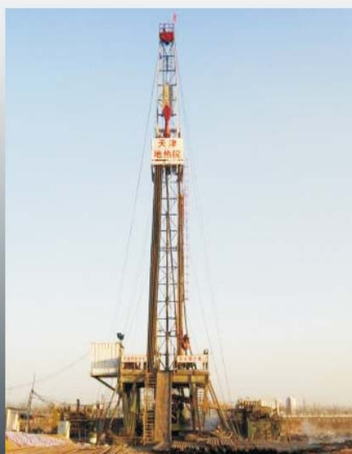
MR7000型钻机已服役32年，累计施工地热井100余眼，总进尺30余万米
