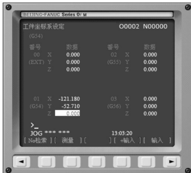
图 1-6 工件坐标系设定窗口
