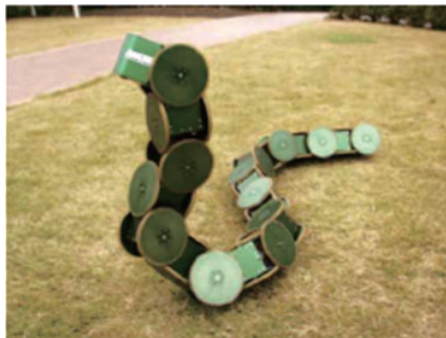
图 1-10 ACM-R3 仿蛇机器人
