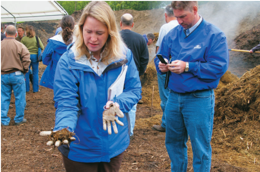
图1-8 感官测定堆肥物料的含水率
